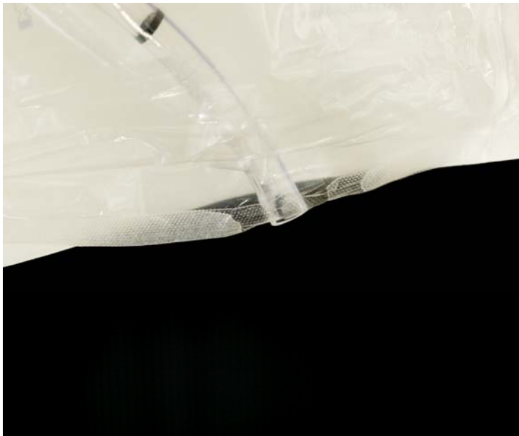
Abb 2 Defekter Tubus in der Verpackung
